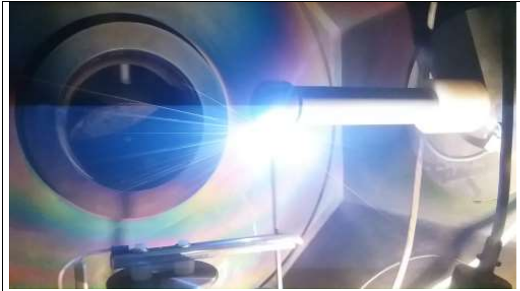
Obr. 4. Experimentálne pracovisko, ktoré umožňuje riadenú inicializáciu skratu.
