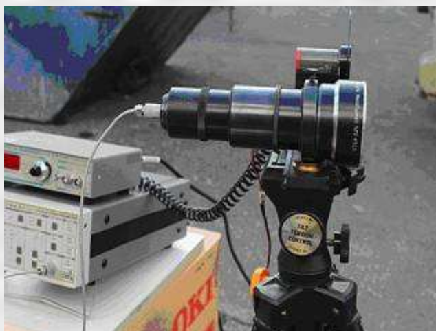
Obr. 3 Vysielač/prijímač s laserovým zdrojom slúžiaci na výskumné účely metód merania rýchlosti cestných vozidiel
