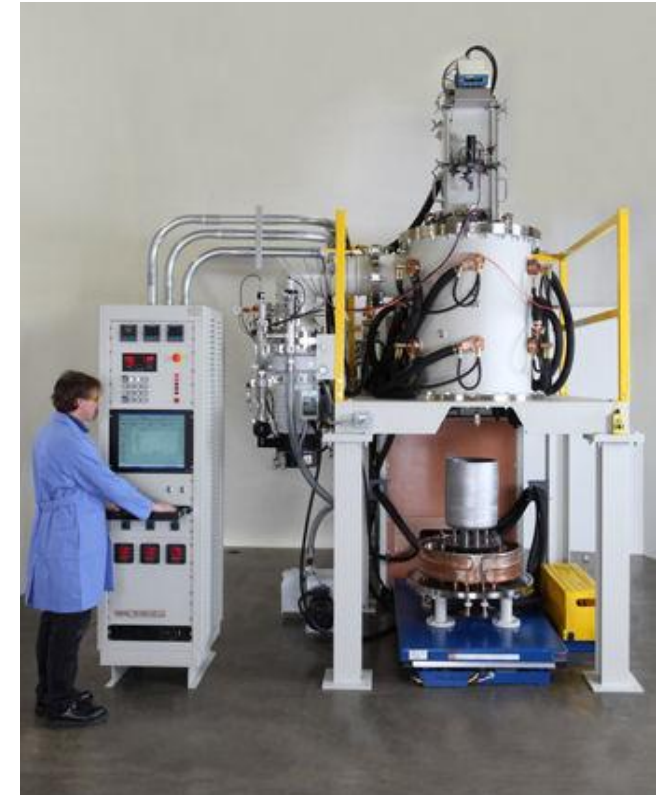
Obr. 5 Stroj s označením K1 spoločnosti Thermal Technology (USA) pre rast zafíru Kyropoulosovou metódou
