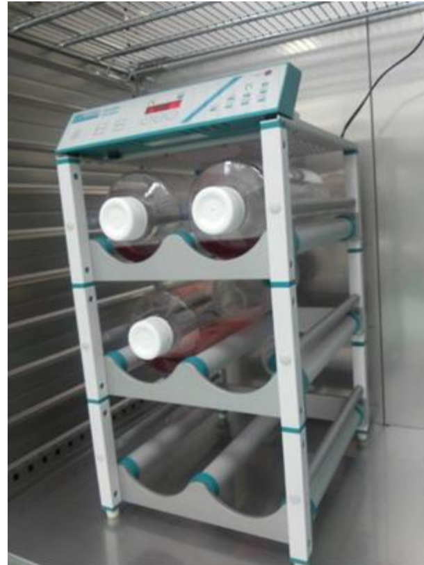
Obrázok č. 4 Príprava vírusu rubeola kmeňa RA27/3 pasáže +2 v pilotnom Working Seed Lot v Roller fľašiach.
