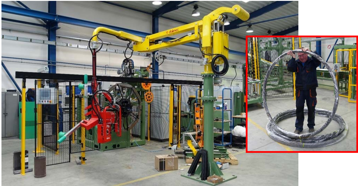
Zariadenie na navíjanie hexagonálnych pätkových lán veľkých rozmerov a pätkové lano s priemerom 1 626 mm
