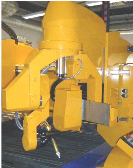
Obr. 11. 3D hlava na jednohorákové rezanie kyslíkom so senzorickým systémom
