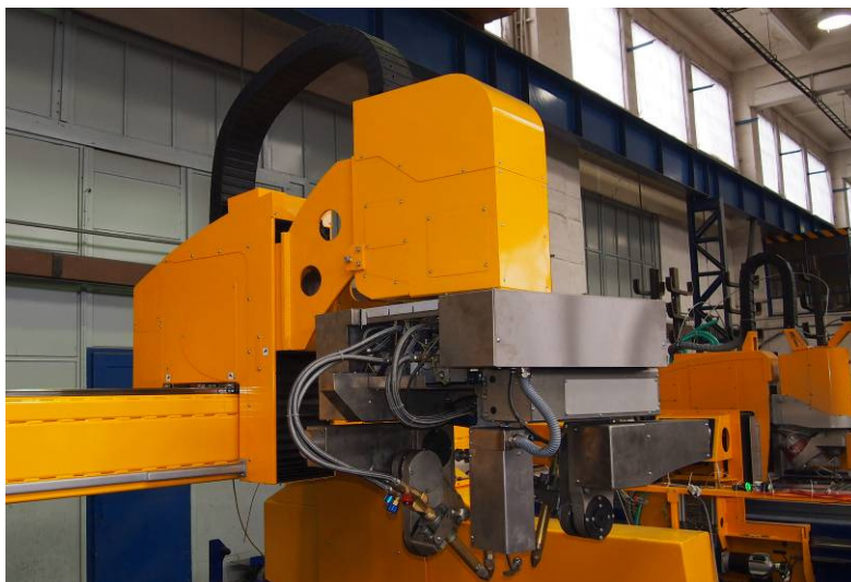
Obr.16. Trojhoráková hlava s automatickým nastavovaním náklonu horákov
