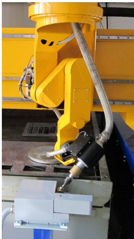
Obr. 1. Pohľad na 3D rezaciu hlavu s náklonom do 120° a s autokalibračným systémom
