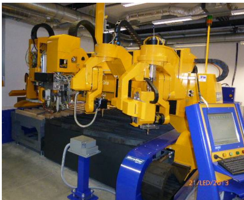
Obr. 25. Skúšobný stend osadený 3D hlavami na rezanie plazmou a kyslíkom
