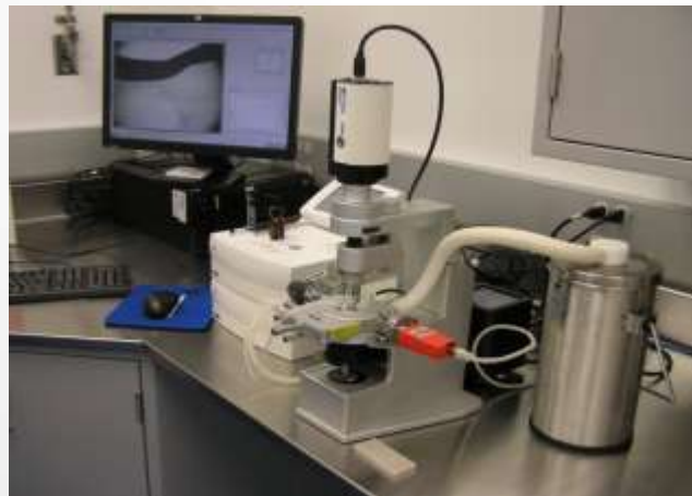
Kryoskop na zistenie kryštalizačnej teploty extraktu antokyánov
