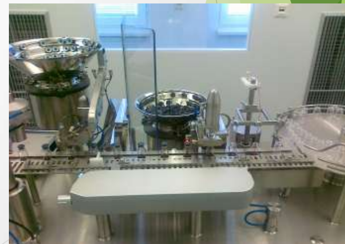
Plnenie extraktu na plniacej linke do lyofilizačných fľaštičiek
