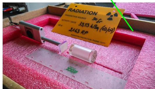
Dáta sa získavali meraním žiarenia kalibračných žiaričov v závislosti od ich vzdialenosti od plastického scintilátora.
